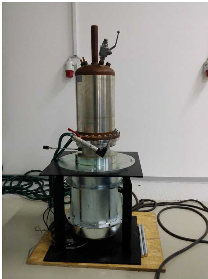
Slika 2: Sestavljen Stirlingov motor v Laboratoriju Inštituta za energetiko
